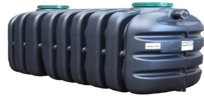
Fosas Sépticas, decantadores digestores fabricados por extrusión soplado, en una sola pieza hasta 5.000 litros, y en doble pared en los modelos a partir de 12.000 litros, con polietileno de alta densidad, lo que garantiza totalmente su estanqueidad e impermeabilidad, consiguiendo una resistencia excepcional a impactos. Todos los modelos están equipados con dos bocas hombre de Ø 400 para facilitar su instalación y mantenimiento.
